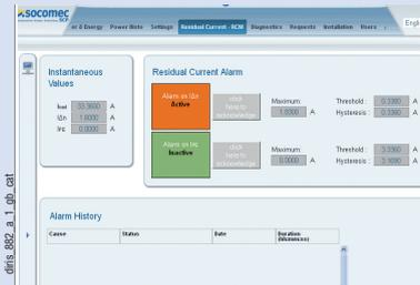
Последним тревогам также присваиваются дата и время. Отображаются длительность и макс. значение (низкое/высокое значение), а также номер соответствующего выхода сигнализации. Данные могут быть извлечены в формате CSV.
