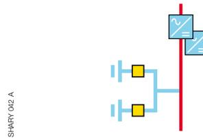
Схема полного резервирования 1+1
