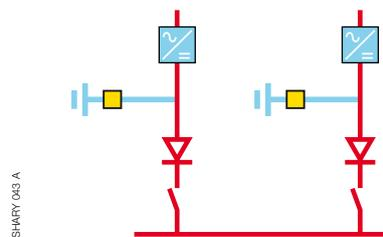
Схема расширенного полного резервирования
